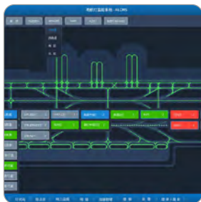
智能助航灯光监控系统
