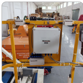
高空作业平台避免撞击系统 Aerial work platform Collision avoidance system
