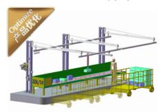
该吸盘助力臂可以协助现场工作人员轻松快速的搬运行李,而不用纯粹靠人力搬运。用于离港时将行李吸附到行李车,运送到停机坪。或者将飞机到岗后拖车运输过来的行李,吸吊搬运到皮带输送线。通过悬挂在上方的高强度铝合金轨道,助力臂的移动范围可以覆盖 16m 长\*3m 宽的月台。
