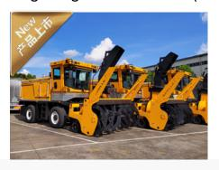
单发动机自研  $4\times4$  静液压驱动专用抛雪车底盘,康明斯 650 马力发动机,非道路国四。四轮转向功能。整车长 8.76 米,转弯半径仅 6.5 米。最高车速: 50 公里 / 小时,最高除雪速度: 35 公里 / 小时,最低稳定速度: 0.15 公里 / 小时。绞龙直径: 1.12、1.32 米,抛雪能力: 3500、5000 吨 / 小时。
